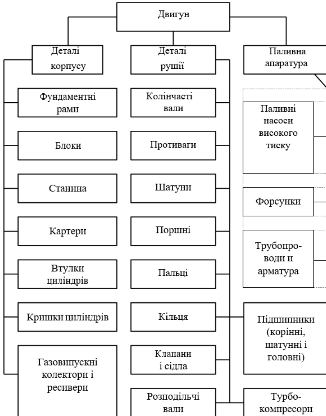
Рис. 2. Класифікація деталей теплових дизельних двигунів сільськогосподарських машин
