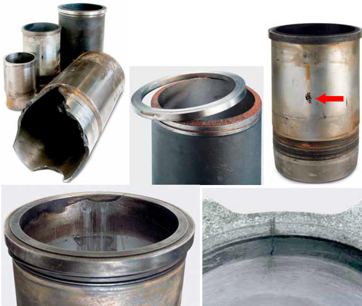
Рис. 6. Експлуатаційні пошкодження втулок: руйнування втулки; обрив буртика; наскрізне пошкодження в результаті кавітації в зоні водяної сорочки; поперечна тріщина і задири робочої поверхні гільзи; поздовжня тріщина
