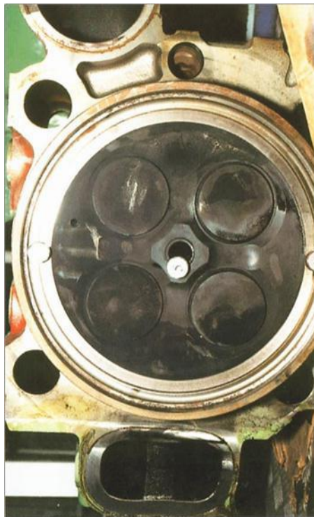
Рис. 8. Кришка дизеля теплових дизельних двигунів сільськогосподарських машин після 1640 мотогодин наробітку
