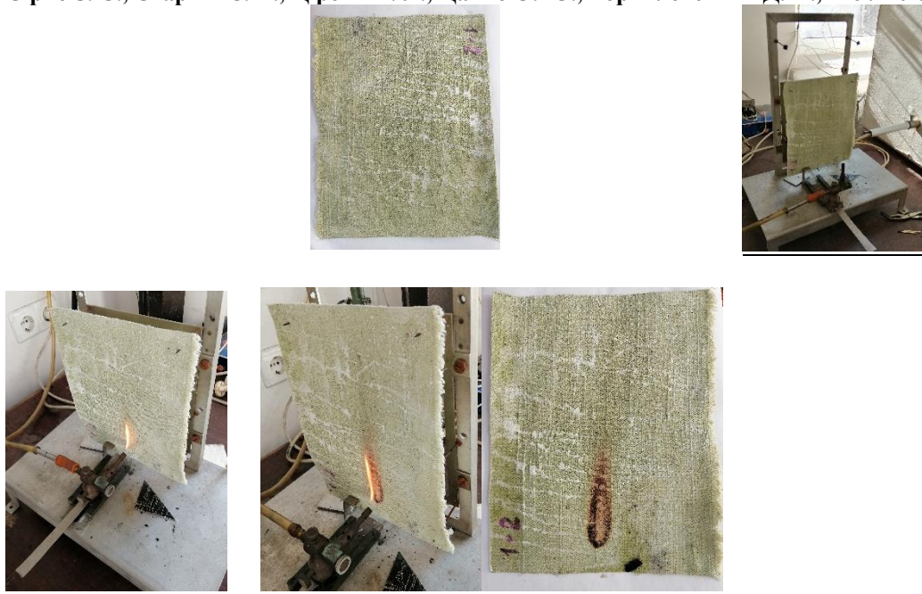
Рис. 1. Випробування на займистість напівлляної тканини СКПВ-11254, яка після експлуатації була оброблена розробленою антипірною композицією
