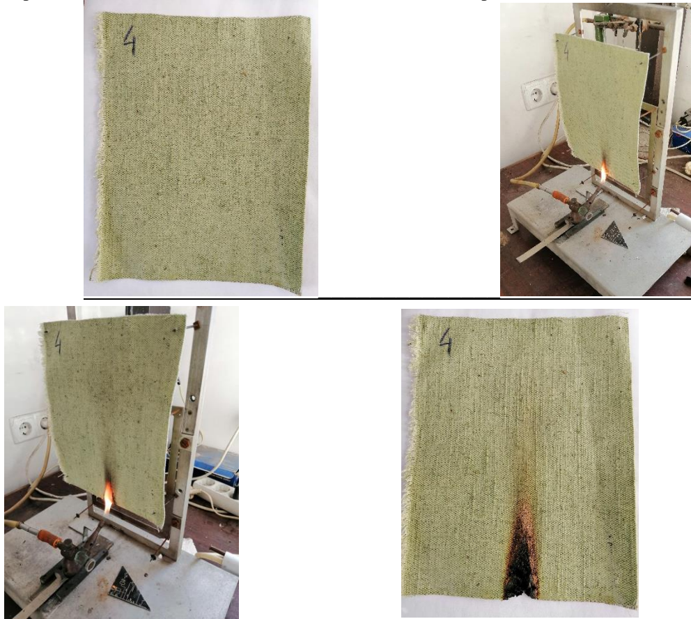
Рис. 2. Випробування на займість наметової тканини, яка після експлуатації 24 місяців була оброблена розробленою антипірною композицією.
