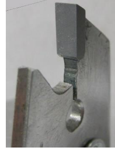
Рис. 3. Зуб дискової пили з пластинкою твердого сплаву
