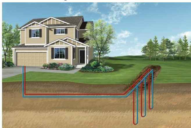
Рис. 3. Геотермальний тепловий насос з вертикальним контуром (система “грунт-вода”)
