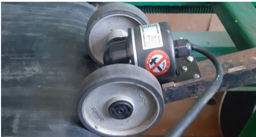
Рис. 3. Розміщення лінійного енкодера ENC Autonics на стрічковому конвеєрі
