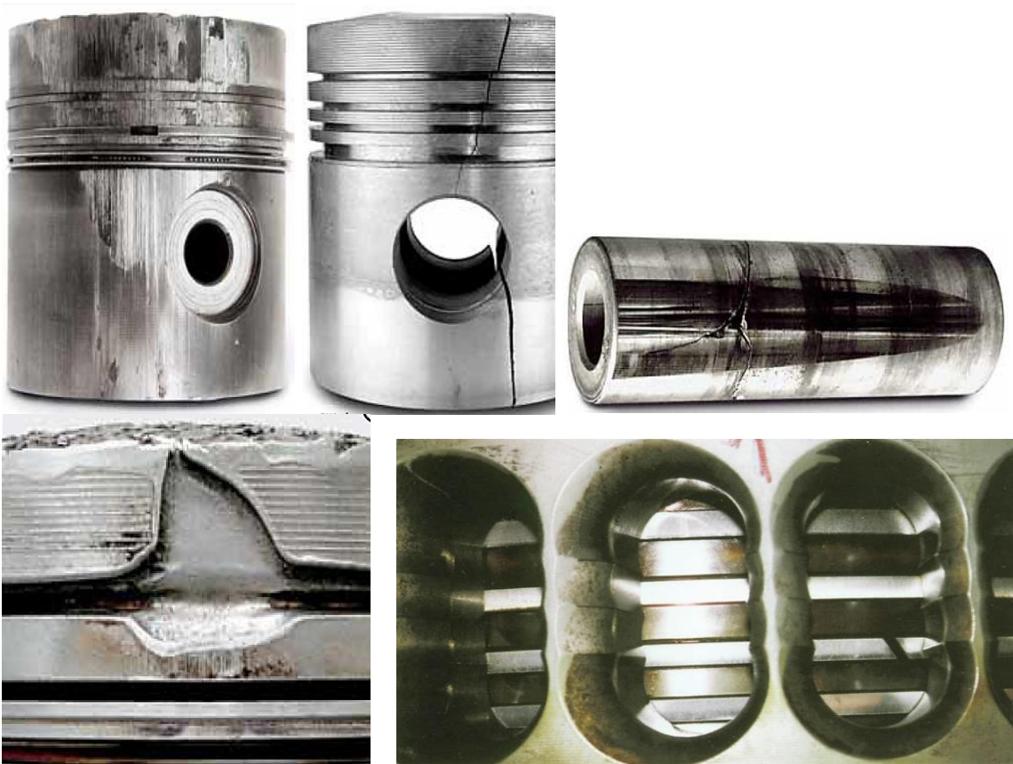
Рис. 12. Задири поверхонь і тріщини поршня і поршневого пальця
