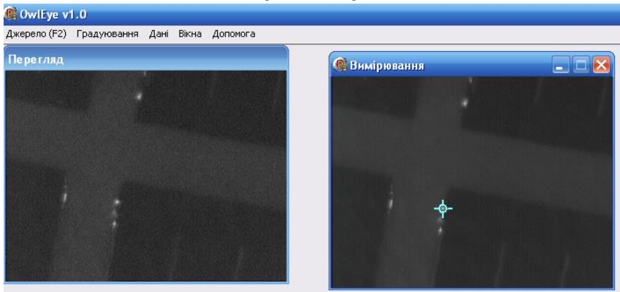
Рис. 3 – Вимірювання яскравості в зоні перехрестя провідних доріжок ФЕСБ при зворотній напрузі 945 В: піксел (позначений круглим маркером) з координатами X=127 , Y=150 має яскравість 194,33 умовні одиниці
