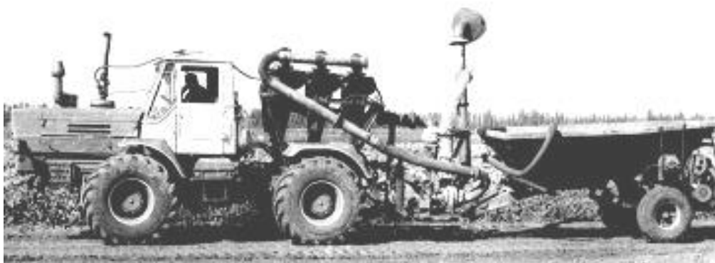
Рис.2. Мобільна установка під час приготування і внесення із дощувальною водою дезактивуючого розчину для нейтралізації небезпечної речовини.
