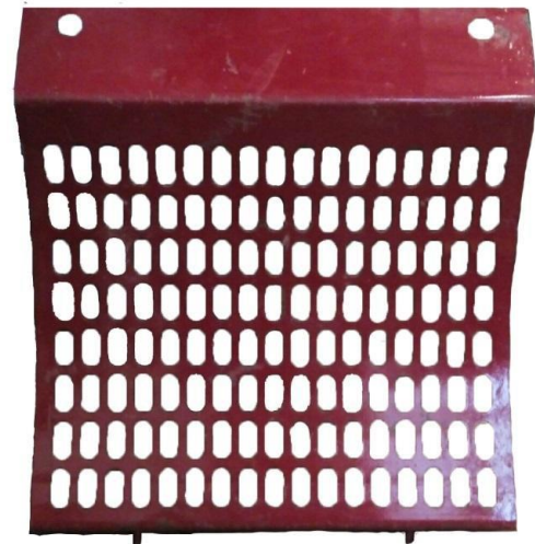
Рис. 1. Схема класичного молотильно-сепарувального пристрою зернозбирального комбайна і загальний вид секції гладкого підбарабання
