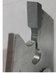
Рис. 3. Зуб дискової пили з пластинкою твердого сплаву
