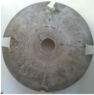
Рис.2. Пилковий диск з клиноподібним вирізом Схема вимірювань
