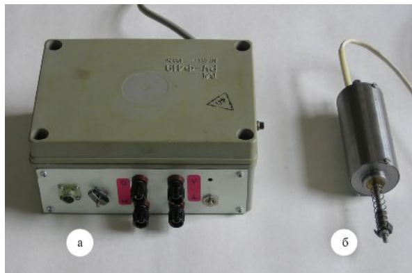
Рис. 3. Індуктивний вимірювач циклічних лінійних переміщень: а – блок обробки інформації; б – індуктивний датчик переміщення
