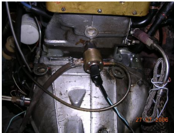
Рис. 2. Датчик тиску, встановлений на двигуні ВАЗ-2105
