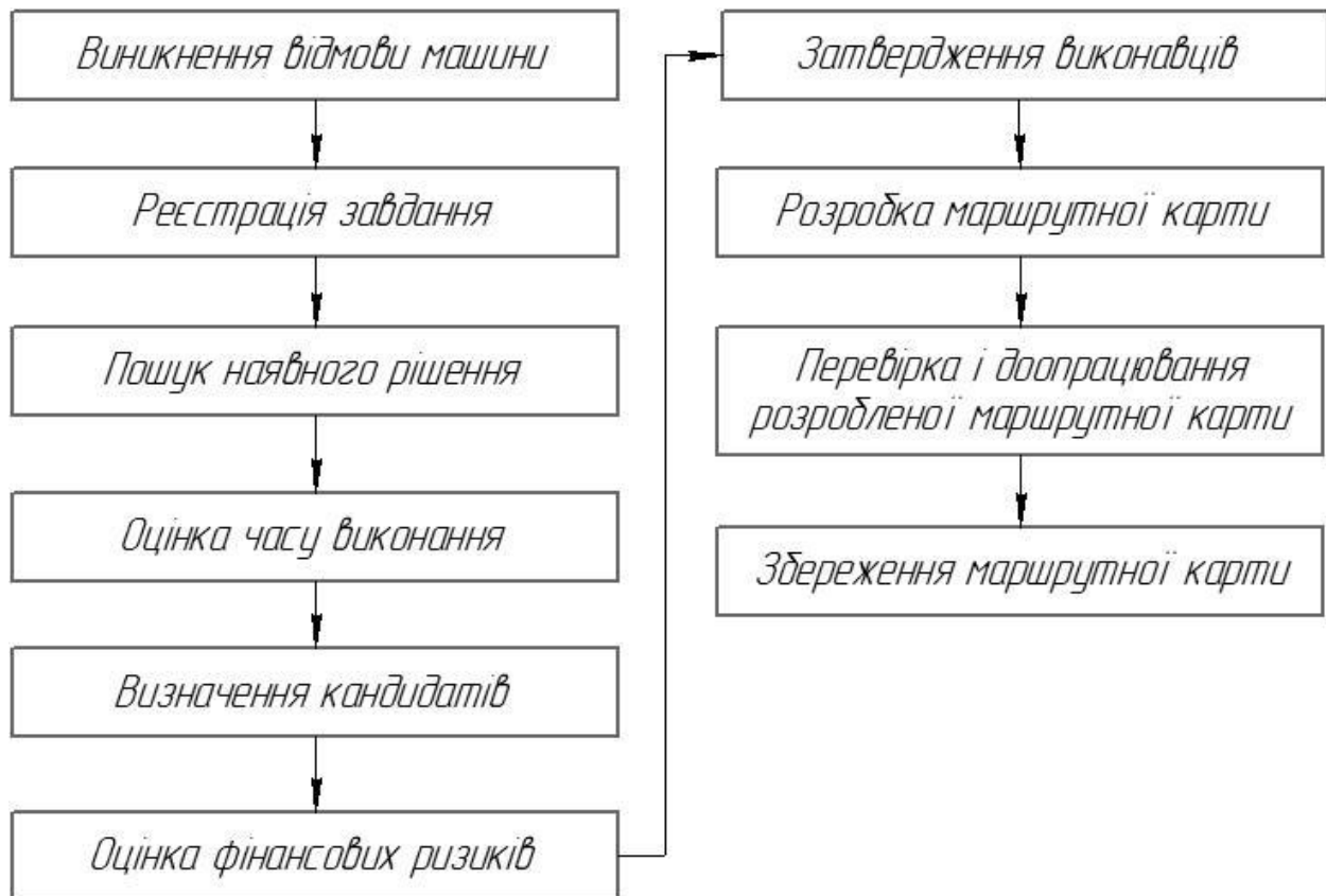
Рис. 2. Алгоритм усунення відмови машини за знеособленою формою організації технічного обслуговування і ремонту
