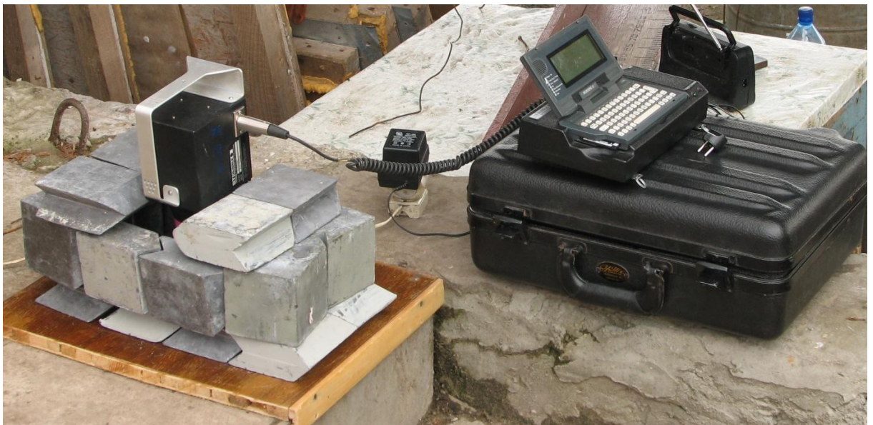
Рис. 1. Загальний вигляд вимірювальної апаратури для визначення вмісту ^{137}\text{Cs} в рибі в місці її вилову без змінювання її товарного вигляду
