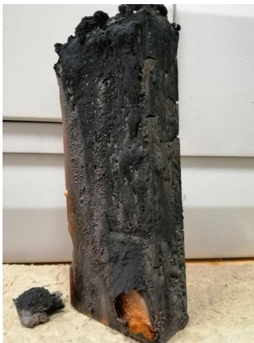
Рис. 2. Результат випробування вогнезахисної деревини
