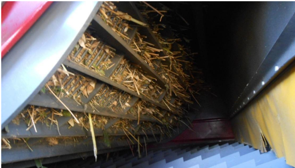
Рис. 14. Процес залипання підбарabanня молотарки під час збирання зернового збіжжя
