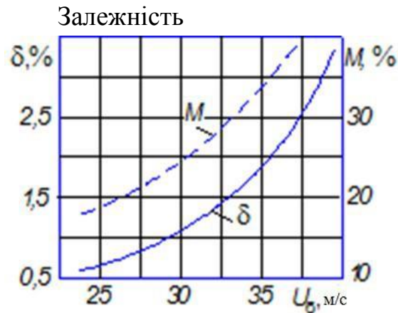
Рис. 6. Вплив колової швидкості бичів на макропошкодження і мікропошкодження зерна
